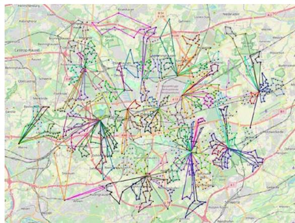
Synthetisches, realitätsnahes Mittelspannungsnetz
